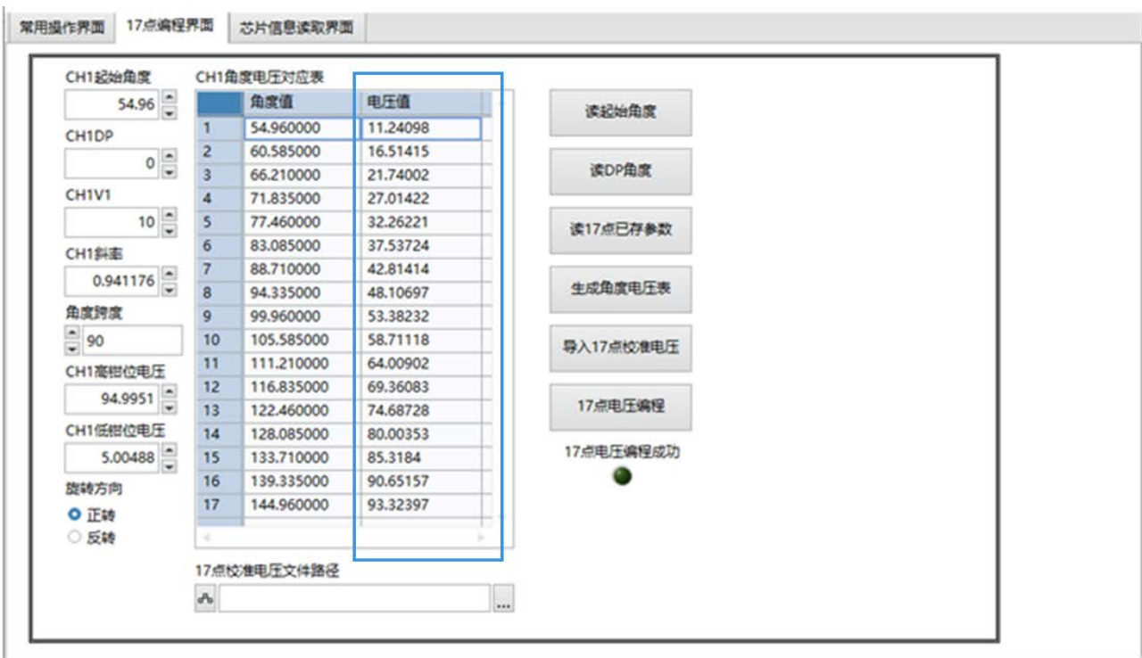
图 5.4.4 填入或导入补偿后的电压值
