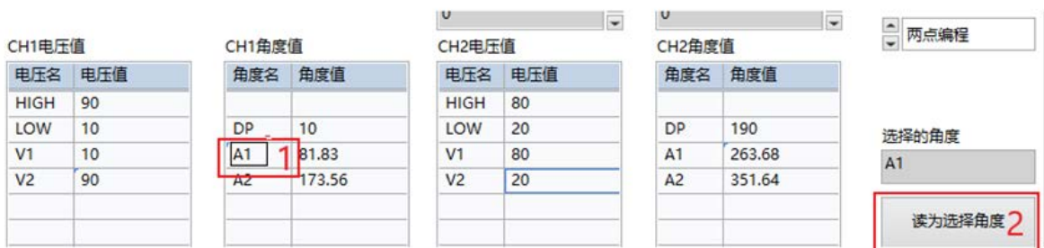
图 5.5.11 读取 A1/A2 编程角度值
