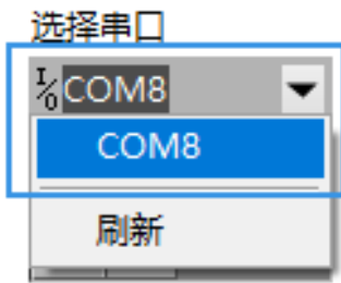
图 5.5.3 选择编程器对应端口号
