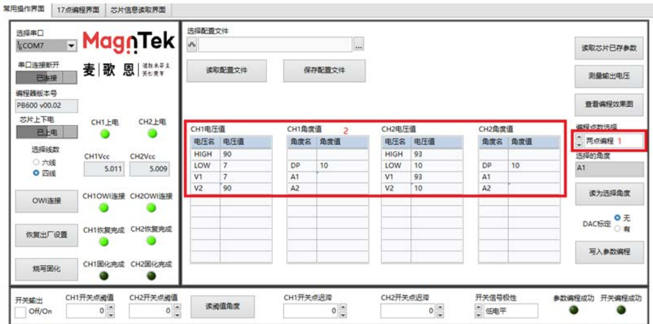
图 5.2.10 选择两点编程并填入固定参数
