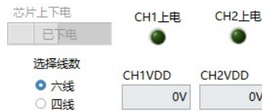
图 4.2.2 芯片上下电按钮及指示灯
