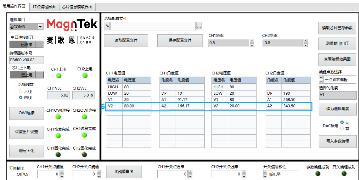
图 5.1.11 通过斜率自动设置 A2 点
