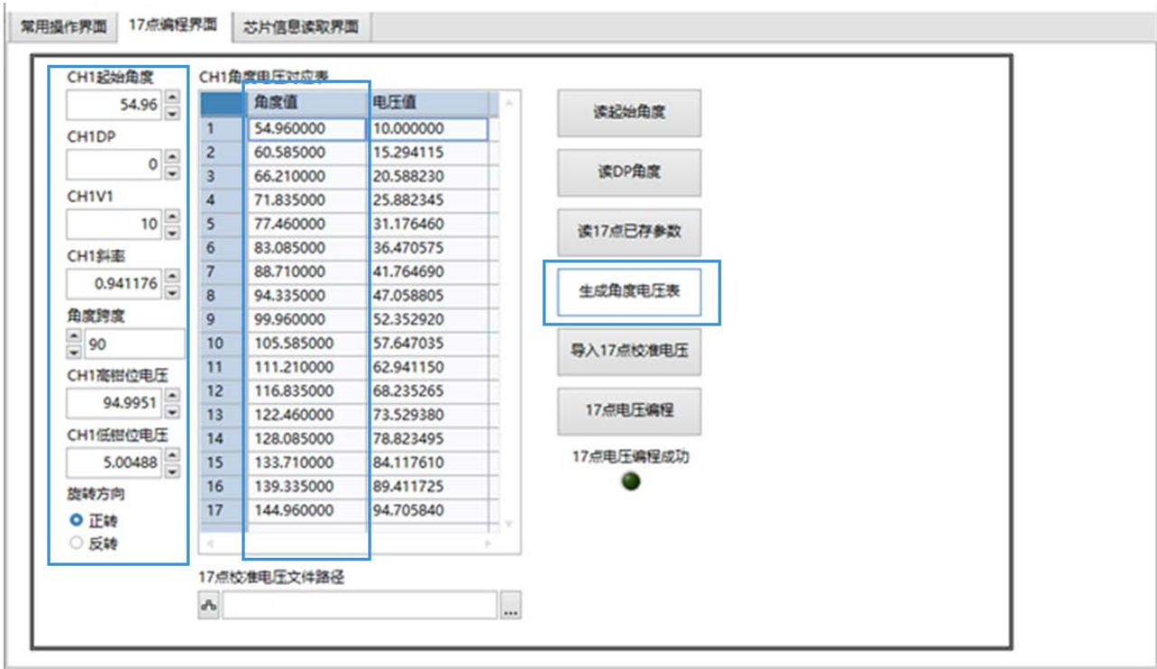
图 5.4.3 填入固定参数并生成角度电压表
