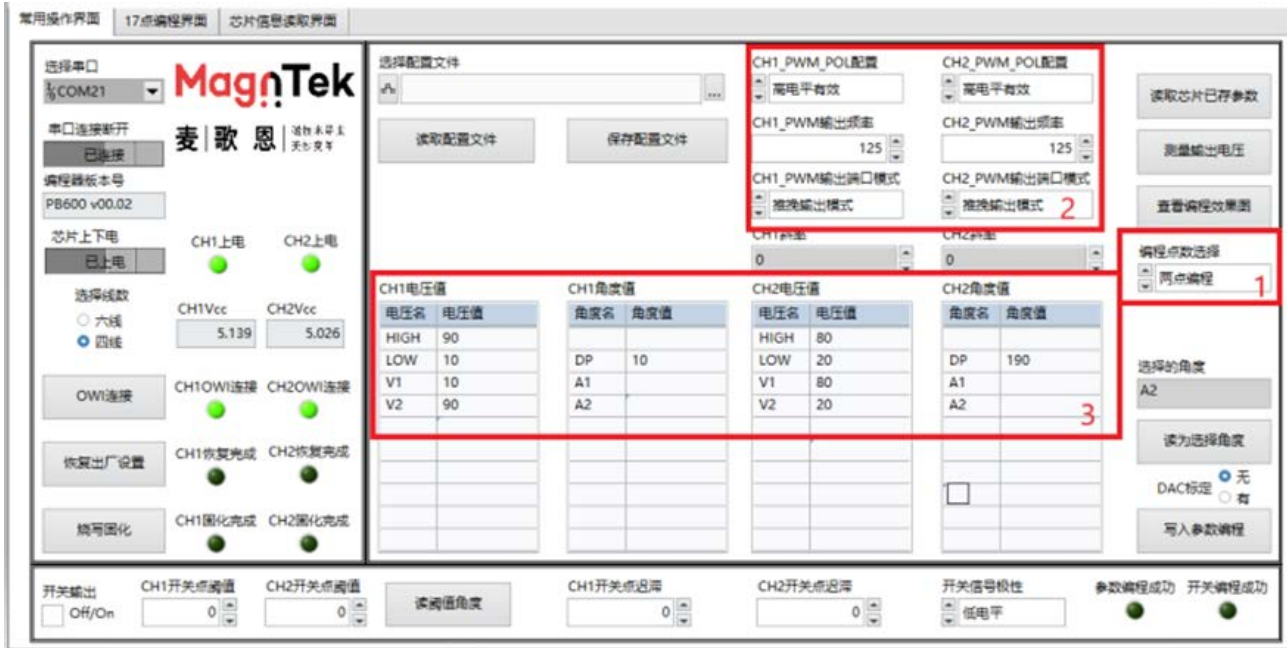
图 5.5.10 选择两点编程并填入固定参数
