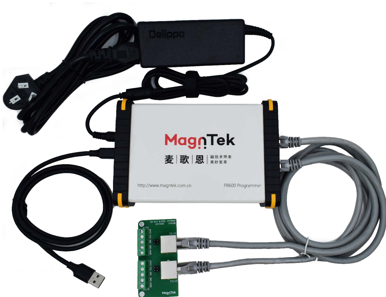
图 1.6 编程器全套连接实物图
