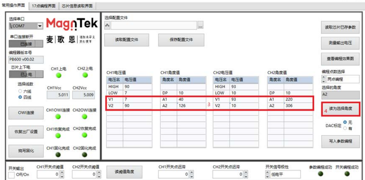
图 5.2.11 读取 A1/A2 编程角度值
